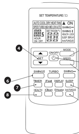
5 Кнопка «**SLEEP**». Она используется для активации ночного режима работы- срок действия 10 часов с момента включения. Если ранее была введена программа таймера, то кондиционер выключится через заданный интервал. Если таймер не был активирован, то кондиционер вернётся к работе с предыдущими настройкам через 10 часов.
