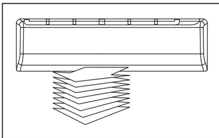
Регулируйте жалюзи горизонтального направления воздушного потока только при выключенных "автоколебаниях" (SWING), если Вы не уверены в своих действиях - выключите кондиционер, и, аккуратно повернув руками первую лопасть на удобный угол, без каких-либо усилий, установите требуемый угол для вертикальных жалюзи!
